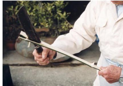
写真6 モトウチの首の部分を使い竹を細く割る
