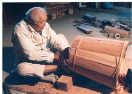
写真8 内側をハリダイで削る
